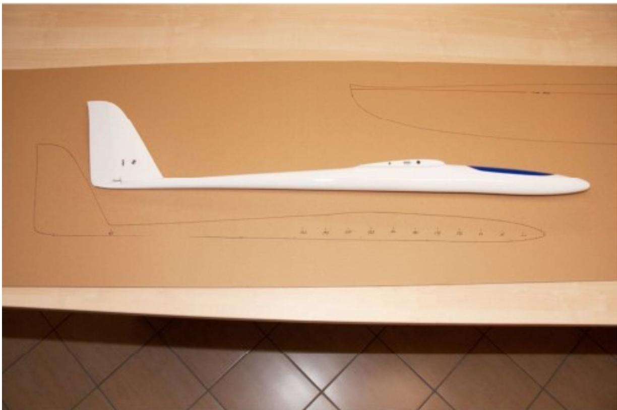
Sollte der Rumpf zwischen Endleiste der Rumpfanformung und Seitenleitwerk Besonderheiten wie zBsp Höhenleitwerk befindet sich vor dem Seitenleitwerk oder der Rumpf verjüngt sich nicht gleichmäßig (speziell bei Scale-Rümpfen), so ist an diesen Stellen gesondert bzw alle 20 cm das Umfangmaß in der Skizze einzutragen.
