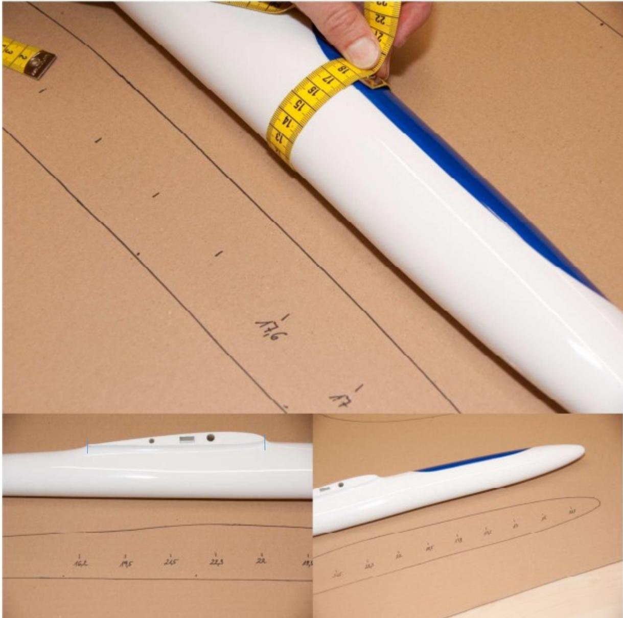
Tragen Sie in der Skizze auch die Umfangmaße - sofern nicht mit den 5cm Abständen ident – der Tragflächenanformung, speziell im Bereich der Nasen und Endleiste ein. Sollte der Rumpf eine Klarglashaube besitzen, bitte auch den Bereich der Haube in der Skizze markieren.
